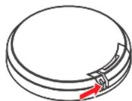
1. 转到遥控背面，向右挤压小凹槽。
