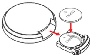
2. 向外拉出电池支架，装入电池 (CR2032)，如图 "+" 极面朝上。
