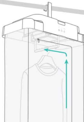
封上布套拉链，接通电源后开机即可烘干衣物
