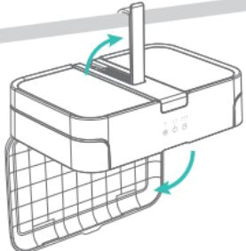
提起干衣机顶面的挂钩，把挂钩挂到平衡、稳固的栏杆上打开产品底盖后，内部的布套自然垂落
